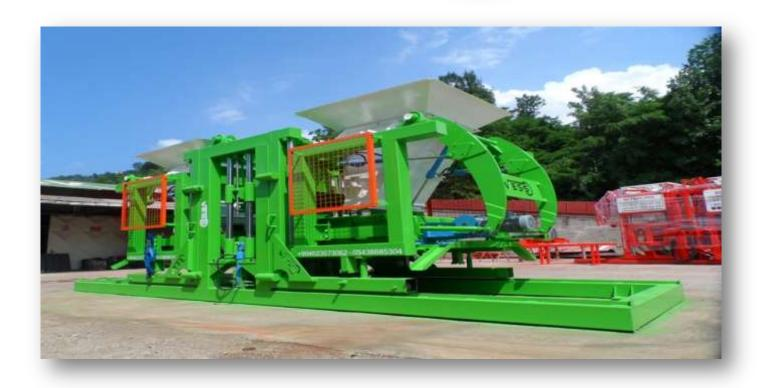
**LOWER VIBRATOR QUANTITY**: 2 x 7,5 kw.SPECIAL COUPLED SERVO-VIBROMOTOR./ **VIBRATOR COOLING FAN:** DUE THE SPECIAL PRODUCTION OF LOW-AMPERAGE THERE IS NO OVERHEATING PROBLEM./ **UPPER VIBRATOR QUANTITY:** 2 x 0,5 kw SPECIAL VIBROMOTOR./ VIBRATION COOLING CAPACITY: 22.000 Kcal. // **ALL VIBRATIONS:** IT GIVES A MINIMUM VIBRATION TO THE MACHINE BODY USING A SPECIAL DAMPENING SYSTEM.
