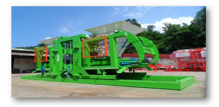
LOWER VIBRATOR QUANTITY : 2 x 7,5 kw. SPECIAL COUPLED SERVO-VIBROMOTOR./ VIBRATOR COOLING FAN: DUE THE SPECIAL PRODUCTION OF LOW-AMPERAGE THERE IS NO OVERHEATING PROBLEM./ UPPER VIBRATOR QUANTITY: 2 x 0,75 kw SPECIAL VIBROMOTOR./ VIBRATION COOLING CAPACITY : 22.000 Kcal. // ALL VIBRATIONS: IT GIVES A MINIMUM VIBRATION TO THE MACHINE BODY USING A SPECIAL DAMPENING SYSTEM.
