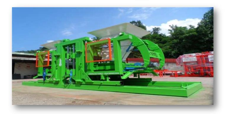
**LOWER VIBRATOR QUANTITY:** 4 x 5,5 kw.SPECIAL COUPLED SERVO-VIBROMOTOR./ **VIBRATOR COOLING FAN:** DUE THE SPECIAL PRODUCTION OF LOW-AMPERAGE THERE IS NO OVERHEATING PROBLEM./ **UPPER VIBRATOR QUANTITY:** 2 x 2,2 kw SPECIAL VIBROMOTOR./ VIBRATION COOLING CAPACITY: 22.000 Kcal. // **ALL VIBRATIONS:** IT GIVES A MINIMUM VIBRATION TO THE MACHINE BODY USING A SPECIAL DAMPENING SYSTEM.
