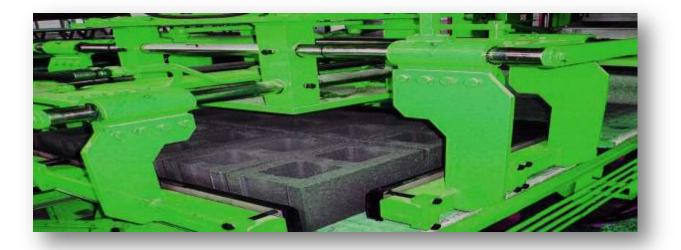
IT IS THE EQUIPMENT THAT STACKS THE DRIED PRODUCTS ON THE EURO PALLET. IT HAS THE CAPABILITY TO TURN AROUND 360°. IS PNEUMATICALLY DRIVEN AND ENSURES ACCURATE PROTECTION AGAINST CONCRETE BLOCK BREAKAGE. UP AND DOWN / RIGHT – LEFT AND GEAR WHEEL ROTATION MOVEMENTS; OPERATING SYSTEM DRIVEN BY SERVO MOTORS WITH REDUCERS. UP AND DOWN 11 kw./ RIGHT – LEFT 4 kw. AND GEAR WHEEL ROTATION 2,2 kw. HEIGHT MEASUREMENT MADE VIA LASER METER.
