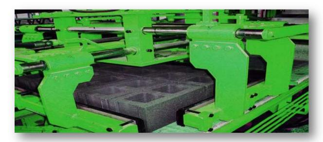
IT IS THE EQUIPMENT THAT STACKS THE DRIED PRODUCTS ON THE EURO PALLET. IT HAS THE CAPABILITY TO TURN AROUND 360°. IS PNEUMATICALLY DRIVEN AND ENSURES ACCURATE PROTECTION AGAINST CONCRETE BLOCK BREAKAGE. UP AND DOWN / RIGHT — LEFT AND GEAR WHEEL ROTATION MOVEMENTS; OPERATING SYSTEM DRIVEN BY SERVO MOTORS WITH REDUCERS. UP AND DOWN 15kw./ RIGHT — LEFT 5,5 kw. AND GEAR WHEEL ROTATION 3 kw. HEIGHT MEASUREMENT MADE VIA LASER METER.
