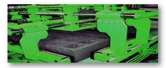
IT IS THE EQUIPMENT THAT STACKS THE DRIED PRODUCTS ON THE EURO PALLET. IT HAS THE CAPABILITY TO TURN AROUND 360°. IS PNEUMATICALLY DRIVEN AND ENSURES ACCURATE PROTECTION AGAINST CONCRETE BLOCK BREAKAGE. UP AND DOWN / RIGHT — LEFT AND GEAR WHEEL ROTATION MOVEMENTS; OPERATING SYSTEM DRIVEN BY SERVO MOTORS WITH REDUCERS. UP AND DOWN 11kw./ RIGHT — LEFT 4 kw. AND GEAR WHEEL ROTATION 2,2 kw. HEIGHT MEASUREMENT MADE VIA LASER METER.
