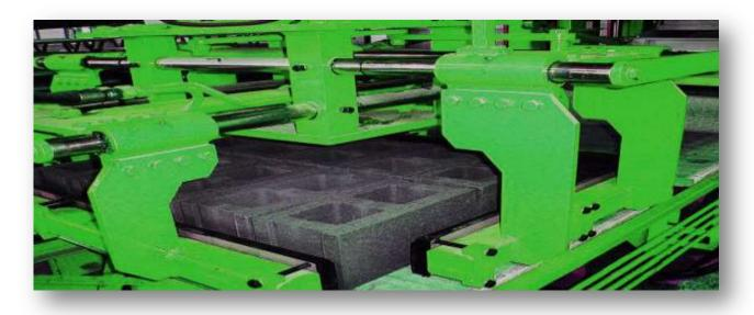
IT IS THE EQUIPMENT THAT STACKS THE DRIED PRODUCTS ON THE EURO PALLET. IT HAS THE CAPABILITY TO TURN AROUND 360°. IS PNEUMATICALLY DRIVEN AND ENSURES ACCURATE PROTECTION AGAINST CONCRETE BLOCK BREAKAGE. UP AND DOWN / RIGHT — LEFT AND GEAR WHEEL ROTATION MOVEMENTS; OPERATING SYSTEM DRIVEN BY SERVO MOTORS WITH REDUCERS. UP AND DOWN 15kw./ RIGHT — LEFT 5,5 kw. AND GEAR WHEEL ROTATION 3 kw. HEIGHT MEASUREMENT MADE VIA LASER METER.
