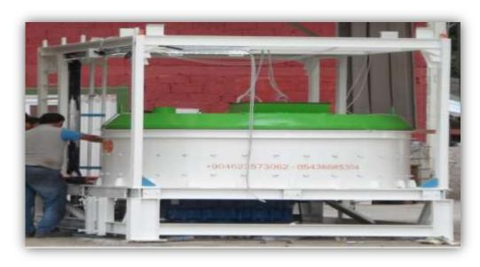
INSTALLATION PLATFORM FOR TWINSHAFT AND PAN TYPE MIXERS. MANUFACTURED USING NPU 120. BESIDES IS A WALKING PLATFORM FOR THE OPERATOR. IS DESIGNED FOR INSTALLATION OF 2 MIXERS.
