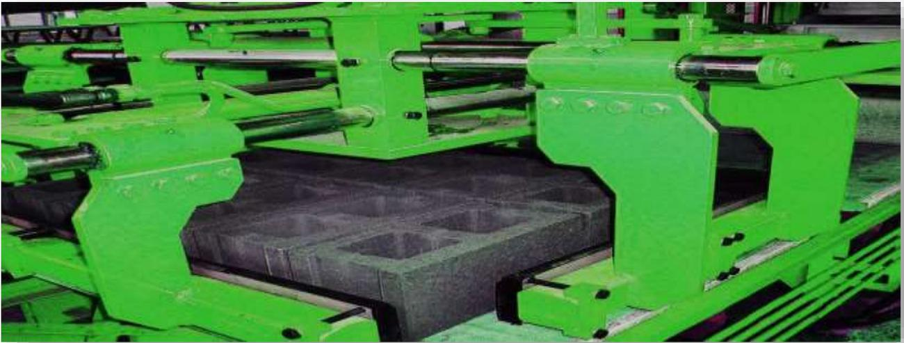
RÉCUPERE LES PRODUITS FINI ET LES PLACE SUR L'EURO PALETTE. IL DISPOSE D'UNE FONCTION DE ROTATION À 360 DEGRÉS. LA PROTECTION DES PRODUITS CONTRE LES MOUVEMENTS HAUT-BAS ET GAUCHE-DROITE SONT ASSURÉS PAR UN SYSTEME PNEUMATIQUE GRACE A DES MOTOR-REDUCTEURS A SERVO. LA PUISSANCE DU MOTOR CONTROLEUR DU MOUVEMENT HAUT-BAS EST DE **11 Kw**, CELLE DE GAUCHE-DROITE EST DE **4 Kw** ET **2.2 Kw** POUR LA ROTATION MACHOIRE LES MESURES DE L'HAUTEURS SONT AUSSI CONTROLÉ PAR DES LASER METRIQUE
