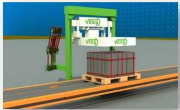
ÉQUIPEMENTS DE CERCLAGES VERTICALE ET HORIZONTALE POUR LES EXPÉDITIONS DE PRODUITS QUI SONT PLACÉ PAR LE PALLETISSEUR SUR LES EURO PALETTE. DE FONCTIONNER ENTièrement AUTOMATIQUE.
