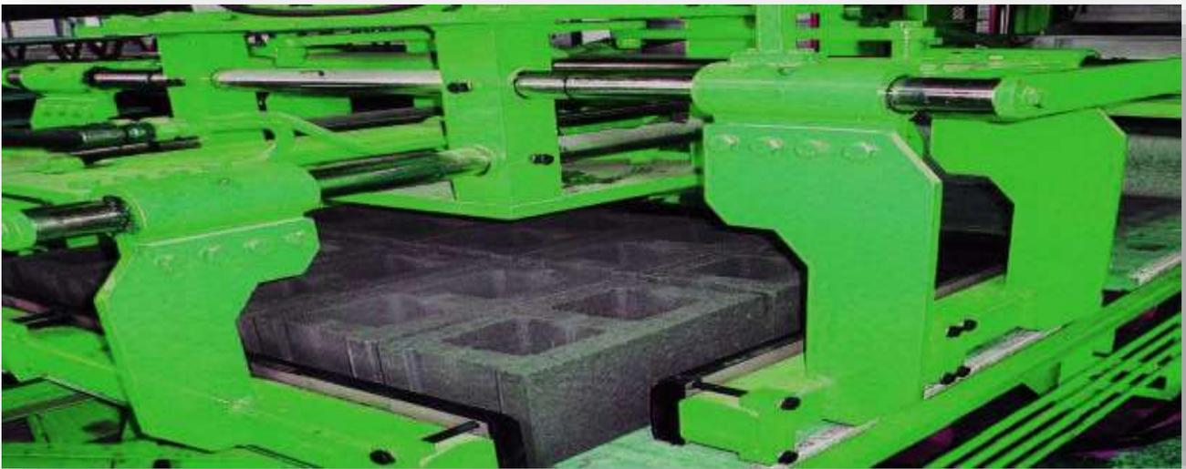
RÉCUPERE LES PRODUITS FINI ET LES PLACE SUR L'EURO PALETTE. IL DISPOSE D'UNE FONCTION DE ROTATION À 360 DEGRÉS. LA PROTECTION DES PRODUITS CONTRE LES MOUVEMENTS HAUT-BAS ET GAUCHE-DROITE SONT ASSURÉS PAR UN SYSTEME PNEUMATIQUE GRACE A DES MOTOR-REDUCTEURS A SERVO. LA PUISSANCE DU MOTOR CONTROLEUR DU MOUVEMENT HAUT-BAS EST DE **15 Kw**, CELLE DE GAUCHE-DROITE EST DE **5,5 Kw** ET **3 Kw** POUR LA ROTATION MACHOIRE LES MESURES DE L'HAUTEURS SONT AUSSI CONTROLÉ PAR DES LASER METRIQUE.
