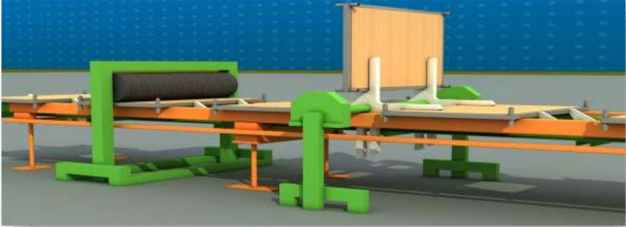
LES DEUX COTÉS DE LA PLANCHES SONT UTILISES DURANT LA PRODUCTION. LA PLANCHE EST RENSERVÉ ET NETTOYÉ CELA NOUS PERMET D UTILIER LES DEUX FAÇE DE PLANCHE AVANT CHAQUE NOUVELLE RECEPTION DE PRODUITS FINIS PAR UN MOTOR-REDUCTEUR DE **1.5Kw**
