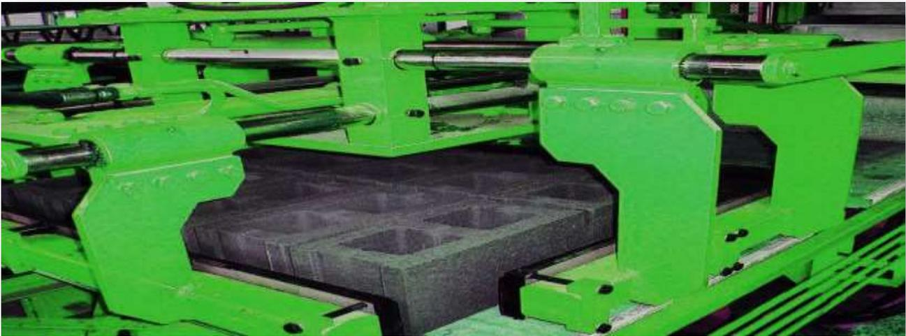
RÉCUPERE LES PRODUITS FINI ET LES PLACE SUR L'EURO PALETTE. IL DISPOSE D'UNE FONCTION DE ROTATION À 360 DEGRÉS. LA PROTECTION DES PRODUITS CONTRE LES MOUVEMENTS HAUT-BAS ET GAUCHE-DROITE SONT ASSURÉS PAR UN SYSTEME PNEUMATIQUE GRACE A DES MOTOR-REDUCTEURS A SERVO. LA PUISSANCE DU MOTOR CONTROLEUR DU MOUVEMENT HAUT-BAS EST DE **15Kw**, CELLE DE GAUCHE-DROITE EST DE **5,5Kw** ET **3Kw** POUR LA ROTATION MACHOIRE LES MESURES DE L'HAUTEURS SONT AUSSI CONTROLÉ PAR DES LASER METRIQUE.
