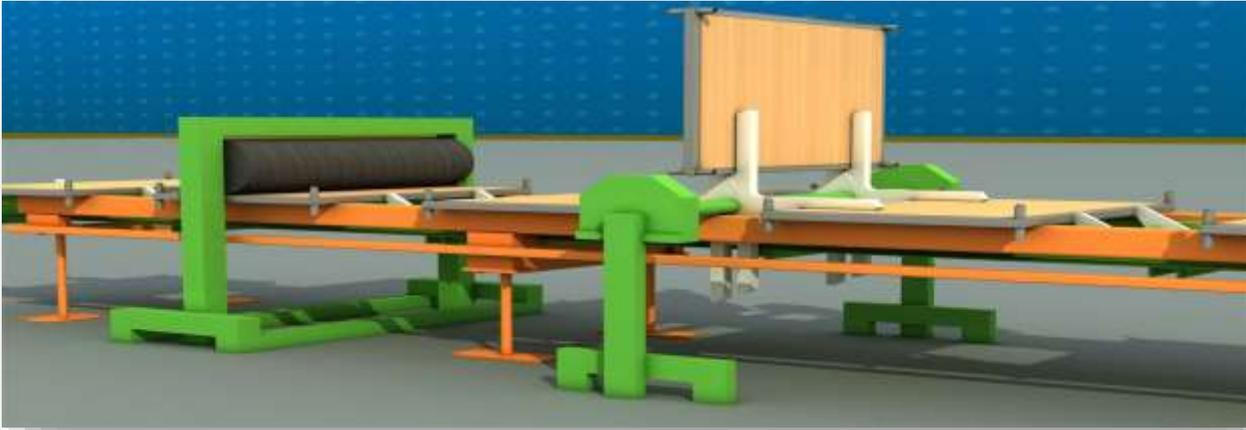
LES DEUX COTÉS DE LA PLANCHES SONT UTILISES DURANT LA PRODUCTION. LA PLANCHE EST RENSERVÉ ET NETTOYÉ CELA NOUS PERMET D UTILIER LES DEUX FAÇE DE PLANCHE AVANT CHAQUE NOUVELLE RECEPTION DE PRODUITS FINIS PAR UN MOTOR-REDUCTEUR DE **1.5Kw**
