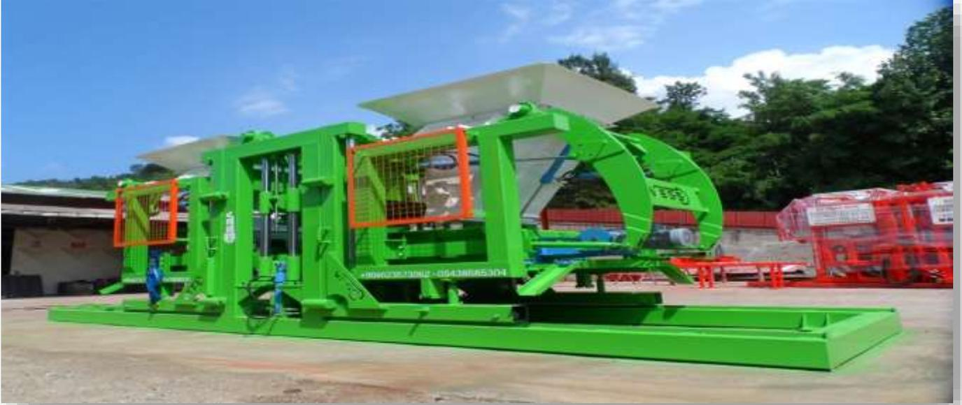
**NOMBRE VIBRATEUR INFÉRIEUR: 4 x 7,5 kw. COUPLÉE AVEC UN SERVO-VIBROMOTOR SPÉCIALE. // VIBRATEURS VENTILATEUR DE REFROIDISSEMENT: EN RAISON DE LA PRODUCTION SPÉCIALE EST FAIBLE AMPÉRAGE PAS EU DE PROBLÈMES RÉCHAUFFEMENT. // VIBRATEUR SUPÉRIEURE: 4 x 2.2 kw VIBROMOTOR SPÉCIALE. // CAPACITÉ DE REFROIDISSEMENT 22.000 kcal // TOUTES LES VIBRATIONS: AVEC SYSTÈME D'AMORTISSEMENT SPÉCIAL DONNE UN MINIMUM DE VIBRATIONS POUR LE CORPS DE LA MACHINE.**
