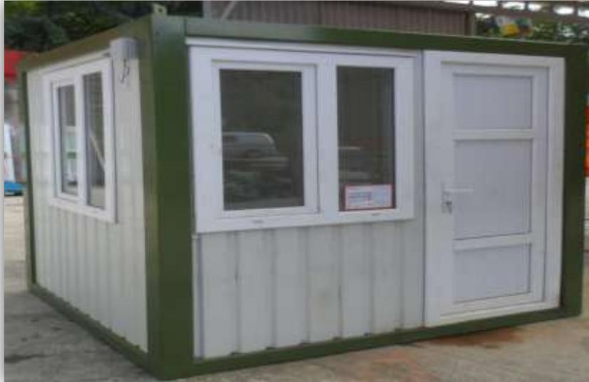
КАБИНА В КОТОРОЙ НАХОДЯТСЯ ВСЕ ПАНЕЛИ УПРАВЛЕНИЯ ЛИНИИ. СТАВИТСЯ ПО СЕРЕДИНЕ ЛИНИИ ДЛЯ ВМЕШАТЕЛЬСТВА ПРИ АВАРИЙНЫХ ОБСТОЯТЕЛЬСТВАХ. ДЛЯ УДОБНОГО КОНТРОЛЯ ПОМЕЩЕНИЯ, КАБИНА ОКРУЖЕНА ИЗОЛИРОВАННЫМ СТЕКЛОМ. ТОЛЩИНА КОРПУСА 3 мм. ДЛЯ ПОВЫШЕНИЯ ПРОЧНОСТИ ИСПОЛЬЗУЕТСЯ СТАЛЬ ГНУТОГО СЕЧЕНИЯ. В ПОКРЫТИИ КАБИНЫ ИСПОЛЬЗУЕТСЯ ИЗОЛЯЦИОННЫЙ МАТЕРИАЛ ПРЕДОТВРАЩАЮЩИЙ ПОПАДАНИЕ ШУМА И ХОЛОДА. ДЛЯ КОМФОРТНОГО УПРАВЛЕНИЯ ОПЕРАТОРА ИМЕЮТСЯ ВСЕ ОСНОВНЫЕ НЕОБХОДИМОСТИ, РОЗЕТКА И Т.Д
