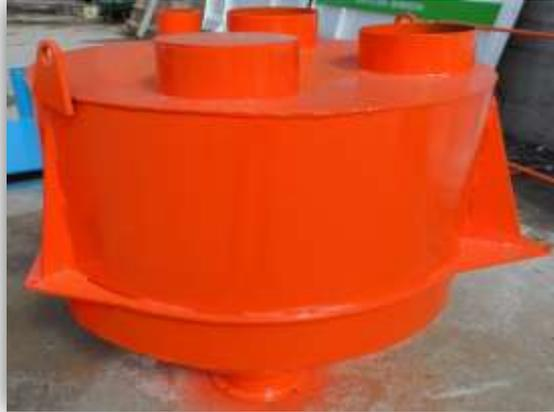
КОМПЛЕКТУЮЩЕЕ КОТОРОЕ ОТПРАВЛЯЕТ НЕОБХОДИМОЕ КОЛИЧЕСТВО ДОЗИРОВАННОГО ЦЕМЕНТА-ВОДЫ-ДОБАВОК В СМЕСИТЕЛЬ. РАЗГРУЗКА ОСУЩЕСТВЛЯЕТСЯ БЛАГОДАРЯ КЛАПАНА. ЗА ДОЗИРОВАНИЕ ОТВЕЧАЮТ ТРИ ТЕНЗОМЕТРИЧЕСКИХ ДАТЧИКОВ (2000 кг). ПРИВОДНЫЕ КЛАПАНЫ МАРКИ WAM ТАКЖЕ ИСПОЛЬЗУЕТСЯ МІКРО SWICH. ВОДА; С ПОМОЩЬЮ РЕЗЕРВУАРА ВОДЫ И ЦИФРОВОГО СЧЕТЧИКА ВОДА ДОБАВЛЯЕТСЯ В РАСТВОР. РЕЗЕРВУАР ДОБАВОК ВМЕЩАЕТ В СЕБЯ 400 кг. ДОБАВКИ. РЕЗЕРВУАР КРАСКИ ВМЕЩАЕТ В СЕБЯ 300 кг. КРАСКИ.
