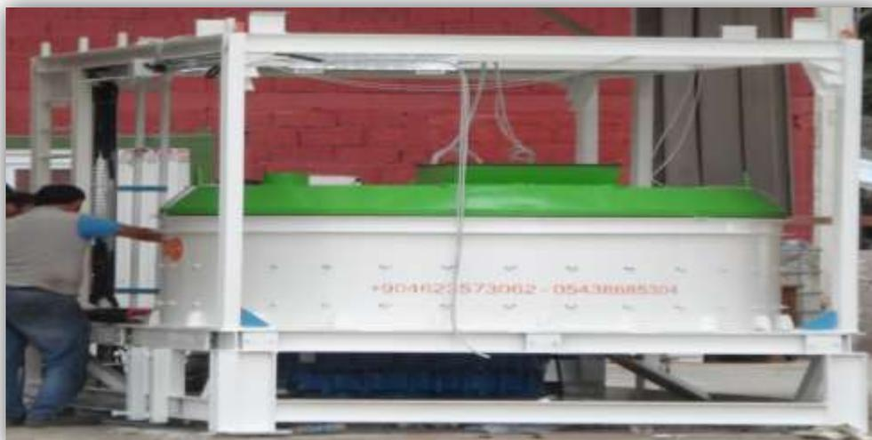
ПЛАТФОРМА НА КОТОРУЮ МОНТИРУЮТСЯ СМЕСИТЕЛЬ ТИПА PAN И SEBRİ. НА ГЛАВНОЙ ШАССИ ИСПОЛЬЗОВАНЫ НПУ 120. ДЛЯ ПОДЪЕМА ОПЕРАТОРА ИМЕЕТСЯ ЛЕСТНИЦА С ПЕРИЛАМИ. ДИЗАЙН ПЛАТФОРМЫ РАЗРАБОТАН ДЛЯ РАЗМЕЩЕНИЯ ДВУХ СМЕСИТЕЛЕЙ.
