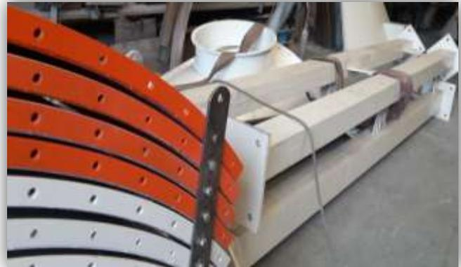
**ДЛЯ УПРОЩЕНИЯ МОНТАЖА; ПО УСМОТРЕНИЮ МОЖЕТ ИЗГОТАВЛИВАЕТСЯ В ДЕМОНТИРОВАННОМ ВИДЕ (ВИНТОВОЙ).**
