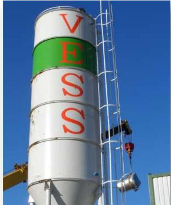
ОБОРУДОВАНИЕ В КОТОРОМ ХРАНИТСЯ ЦЕМЕНТ ИСПОЛЗУЕМЫЙ В ИЗГОТОВЛЕНИИ РАСТВОРА. НА СИЛОСЕ ИМЕЕТСЯ ЛЕСТНИЦА СПУСКА. ОБЪЕМ СИЛОСА 200 ТОННЫ СО СМЕННЫМ ТОП ФИЛЬТРОМ. ТАК ЖЕ НА СИЛОСЕ НАХОДЯТСЯ ДВА СЕНСОРНЫХ ДАТЧИКА УРОВНЯ И ПРЕДОХРАНИТЕЛЬНЫЙ КЛАПАН. НА ВЫПУСКНОЙ ВОРОНКЕ ИМЕЕТСЯ КЛАПАН С РУКОЯТКОЙ МАРКИ WAM. ДЛЯ ВЫСЫПАНИЯ ЦЕМЕНТА В ШНЕК. КОНСТРУКЦИЯ СИЛОСА СОСТОИТ ИЗ ЖЕСТИ ТОЛЩИНОЙ 5/6 мм. И ПРИ НЕОБХОДИМОСТИ МОЖЕТ БЫТЬ ИЗГОТОВЛЕНА РАЗНОЙ ЕМКОСТИ.
