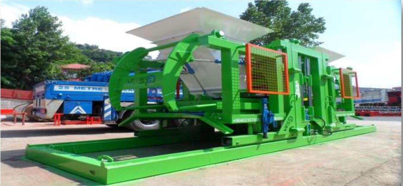
ДНИЩЕ ФОРМОВОЧНОГО АГРЕГАТА: HARDOX 450
