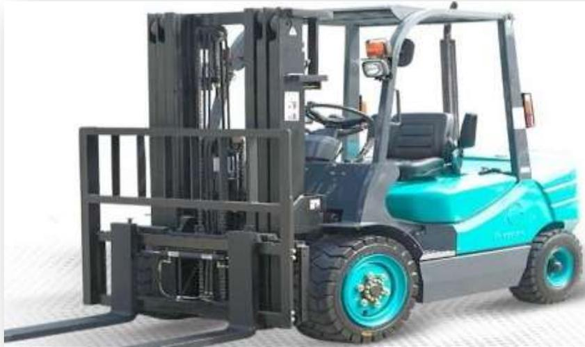
ИСПОЛЬЗУЕТСЯ ДЛЯ ПЕРЕВОЗКИ ПОДДОНОВ ИЗ РОБОТА НАКОПИТЕЛЯ В КОМПАТУ СУШКИ, И ПОДДОНЫ ИЗ КОМНАТЫ СУШКИ ПЕРЕВОЗИТ К ЗАДНЕМУ РОБОТУ РАСФАСОВЩИКУ. ТАКЖЕ, ПЕРЕВОЗИТ УПАКОВАННЫЕ ИЗДЕЛИЯ ГОТОВЫЕ ДЛЯ ОТГРУЗКИ, НА СКЛАД. ДИЗЕЛЬНЫЙ - ЯПОНСКИЙ МАРКИ ISUZU, ОБЪЕМ МОЩНОСТИ 3 ТОННЫ, ВЫСОТА ПОДЪЕМА 4.20 мт.
