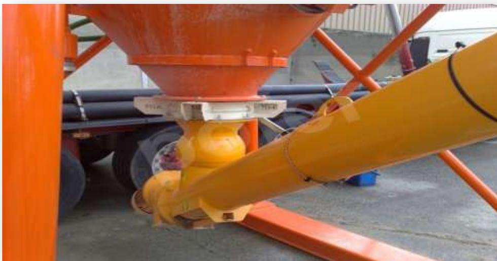
ОБЕСПЕЧИВАЕТ ПЕРЕДАЧУ ЦЕМЕНТА ИСПОЛЬЗУЕМОГО В РАСТВОРЕ ИЗ СИЛОСА В СИСТЕМУ ВЗВЕШИВАНИЯ. МАРКА WAM 8' (Ø219 ММ) МОЩНОСТЬ ДВИГАТЕЛЯ 9.2 кВт. КРЕПЛЕНИЕ К СИЛОСУ МОЖЕТ ПОВОРАЧИВАТЬСЯ В ЛЕВО-ПРАВО.
