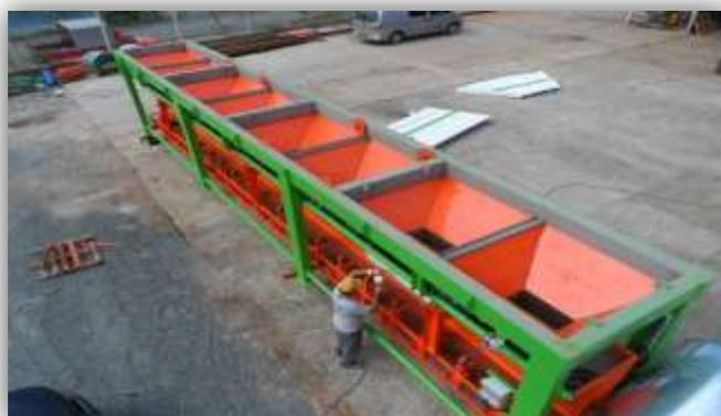
**(02) – КОНВЕЙЕРНАЯ ЛЕНТА 25 x 4 = 100 м<sup>3</sup> БУНКЕРА С СИСТЕМОЙ ВЗВЕШИВАНИЯ ( 18 м. )**
