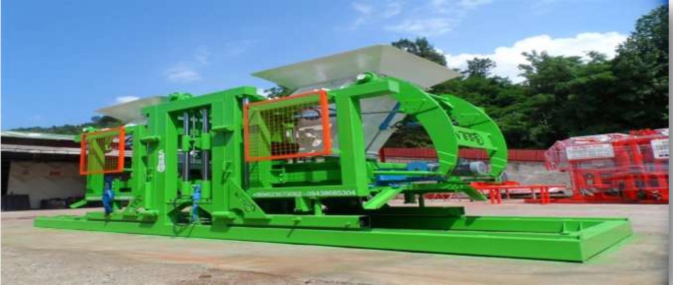
**КОЛИЧЕСТВО НИЖНИХ ВИБРАТОРОВ:** 4 x 7,5 кВт. СПЕЦИАЛЬНЫЕ ACUPLE SERVO-ВИБРОДВИГАТЕЛИ. // **ВЕНТИЛЯЦИЯ ОХЛАЖДЕНИЯ ВИБРАТОРА:** ПРОБЛЕМЫ С ОХЛАЖДЕНИЕМ НЕ ВОЗНИКАЮТ БЛАГОДАРЯ СПЕЦИАЛЬНОМУ ПРОИЗВОДСТВУ С НИЗКИМ АМПЕРОМ. // **КОЛИЧЕСТВО ВЕРХНИХ ВИБРАТОРОВ:** 4 x 2,2 кВт. ВИБРОДВИГАТЕЛИ СПЕЦИАЛЬНОГО ПРОИЗВОДСТВА.// **ОБЪЕМ ОХЛАЖДЕНИЯ ВИБРО ДВИГАТЕЛЕЙ:** 22.000 Ккал // **ВСЯ ВИБРАЦИЯ:** БЛАГОДАРЯ СПЕЦИАЛЬНОЙ СИСТЕМЫ ДЕМПФИРОВАНИЯ ДАЕТ МИНИМАЛЬНУЮ ВИБРАЦИЮ НА КОРПУС СТАНКА.
