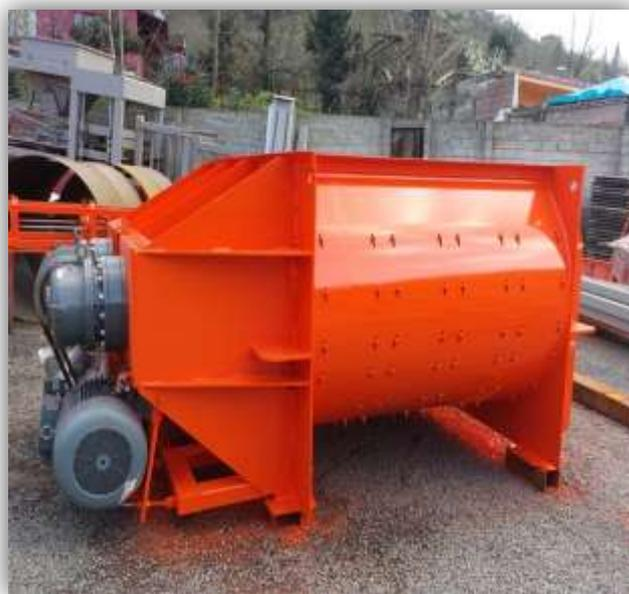
СМЕШИВАЕТ СЫРЬЕ В ОДНОРОДНЫЙ РАСТВОР. МОЩНОСТЬ ДВИГАТЕЛЕЙ 2 x 90 кВт. ПРАКТИЧНЫЙ ДИЗАЙН ПОЗВОЛЯЕТ МЕНЯТЬ ВАЛ. БОКОВАЯ ЛИСТОВКА, ЛОПАСТЬ ВАЛА, ЛИСТОВКА ПРОТИВ ИЗНОСА ПОКРЫТА СТАЛЬЮ МАРКИ HARDOX / ST 52 – A1.
