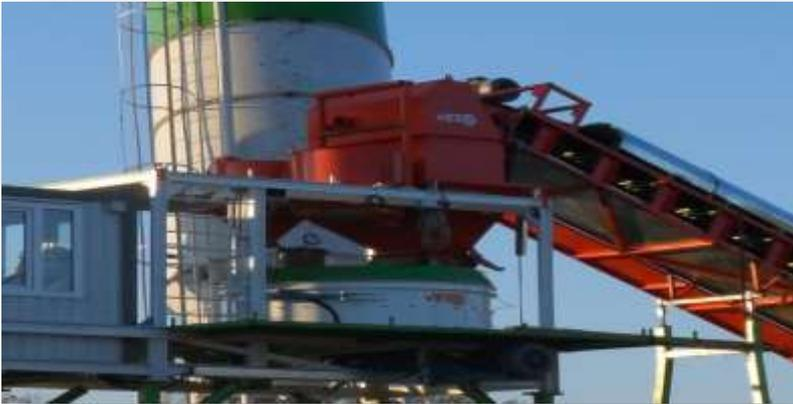
**ЦЕМЕНТ:** СИСТЕМА КОТОРАЯ ВЗВЕШИВАЕТ НЕОБХОДИМОЕ КОЛИЧЕСТВО ЦЕМЕНТА И ОТПРАВЛЯЕТ В СМЕСИТЕЛЬ. МАКСИМАЛЬНЫЙ ОБЪЕМ ЦЕМЕНТА **650кг.** В СИСТЕМЕ ИМЕЮТСЯ **3** ТЕНЗОДАТЧИКА (LOAD CELL) ВЕСОВОЙ НАГРУЗКИ **500кг.** МИКРО ПЕРЕКЛЮЧАТЕЛИ (MIKRO SWITCH) ,МАРКА КЛАПАНОВ С СИЛОВЫМ ПРИВОДОМ WAM. **ДОБАВКИ :** ОБОРУДОВАНИЕ ОБЕСПЕЧИВАЕТ ПЕРЕВОД ИЗ СИЛОСА В СИСТЕМУ, ВЗВЕШИВАЯ ЦЕМЕНТ ИСПОЛЬЗУЕМЫЙ В СМЕСИ. ОБЪЕМ СИСТЕМЫ **50кг.** СИСТЕМУ ВЗВЕШИВАЕТ ТЕНЗОДАТЧИК **1**
