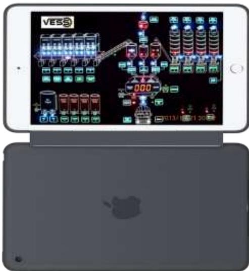
**СИСТЕМА УПРАВЛЕНИЯ-КОНТРОЛЯ КОМПЬЮТЕРОМ (SCADA) (ОПЦИОНАЛЬНО):** КОМАНДНО- КОНТРОЛЬНЫЕ ОПЕРАЦИИ, ОТЧЕТЫ, ПОКАЗАНИЯ НЕДОСТАТОЧНОСТИ, КОНТРОЛЬНО КОМАНДНЫЕ ОПЕРАЦИИ КОМПЬЮТЕРА, ПРИНТЕРА SIEMENS, SCADA, ПОКАЗЫВАЮТСЯ НА ЭКРАНЕ КОМПЬЮТЕРА С ПОДДЕРЖКОЙ АНИМАЦИИ.МОЖНО ЗАПИСАТЬ ЖЕЛАЕМОЕ КОЛИЧЕСТВО РАСТВОРОВ, ВВОДИТЬ ДАННЫЕ О КЛИЕНТАХ, ТРАНСПОРТНОМ СРЕДСТВЕ.КРОМЕ ТОГО ЕСТЬ ВОЗМОЖНОСТЬ ПОЛУЧАТЬ ИНФОРМАЦИЮ ЗА ПРОШЛЫЙ ГОД ПРОИЗВОДСТВА.
