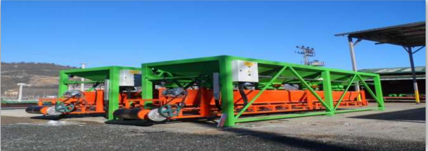
ЛЕНТОЧНЫЙ КОНВЕЙЕР ВЗВЕШИВАЯ МАТЕРИАЛЫ, ПЕРЕДАЕТ ИЗ БУНКЕРА ИНЕРТНЫХ, НА ЛЕНТУ ПЕРЕДАЧИ ИНЕРТНЫХ МАТЕРИАЛОВ. ЛЕНТА РАСПОЛОЖЕНА ПОД БУНКЕРОМ ИНЕРТНЫХ МАТЕРИАЛОВ. КОНСТРУКЦИЯ **СОСТОИТ ИЗ ПЯТИ КОМПОНЕНТОВ** (ЕМКОСТЬ ВЗВЕШИВАНИЯ, ШАССИ, РЕЗИНОВАЯ ЛЕНТА КОНВЕЙЕРА И РОЛИКИ, СИСТЕМА ВЗВЕШИВАНИЯ, МОТОР И РЕДУКТОРЫ.)
