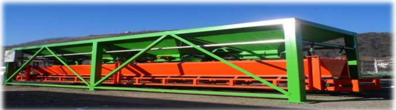
**(03) –КОНВЕЙЕРНАЯ ЛЕНТА (20 м.\* 80 см.\* 10 мм. -4 СЛОЙ)**
