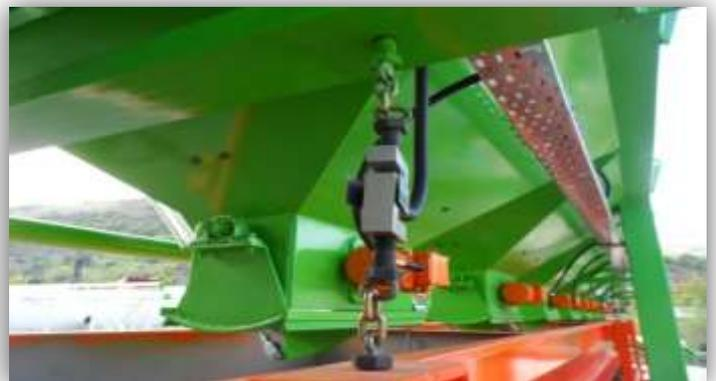
**РЕЗЕРВУАР ВЗВЕШИВАНИЯ:** РЕЗЕРВУАР В КОТОРЫЙ ВЫСЫПАЕТСЯ ИНЕРТНЫЙ МАТЕРИАЛ ИЗ БУНКЕРА, ДЛЯ ВЗВЕШИВАНИЯ, ИЗГОТОВЛЕН ИЗ СТАЛИ ТОЛЩИНОЙ 5мм. ДЛЯ ПОВЫШЕНИЯ ПРОЧНОСТИ, ЕМКОСТЬ ПРОИЗВОДИТСЯ ВИТОЙ. НА ЛЕНТЕ ИМЕЮТСЯ РЕЗИНОВЫЕ ВЫСТУПЫ ПРОТИВ РАССЫПАНИЯ ИНЕРТНЫХ, ЧТО БЫ ПРОДЛИТЬ СРОК ПРОЧНОСТИ ЛЕНТЫ. ИМЕЕТСЯ ВОЗМОЖНОСТЬ МОНТИРОВАТЬ И ДЕМОНТИРОВАТЬ РЕЗЕРВУАР.
